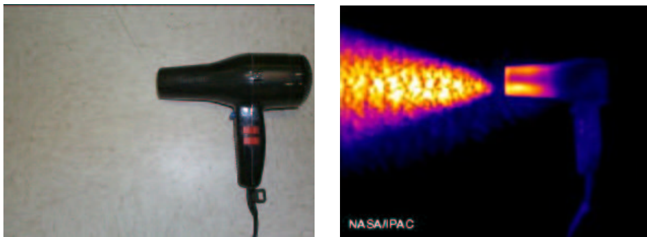
FIGUUR 10 — Links: Een werkende haardroger, gefotografeerd in zichtbaar licht. De hete lucht is niet heet genoeg om zichtbaar licht uit te stralen. Rechts: Dezelfde werkende haardroger, nu gefotografeerd in infrarood licht. De hete lucht straalt helder op infrarode golflengten. Foto: NASA/IPAC.
